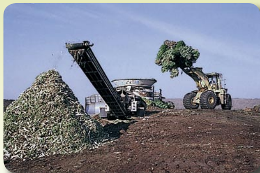
Rác cây cỏ đang được xay thành phân bón và gỗ phủ tại bãi rác Miramar (Miramar Landfill).
